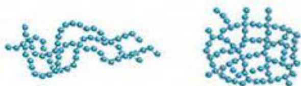
D3.6: Een schematische weergave van een thermoplast (links) en een thermoharder (rechts).
